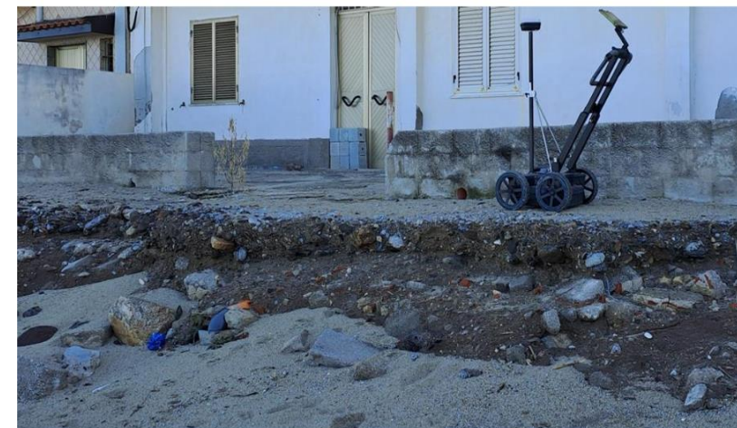
Figura 9 Depositi alluvionali misti a riporti antropici in corrispondenza dell'abitato di loc. Pennello
