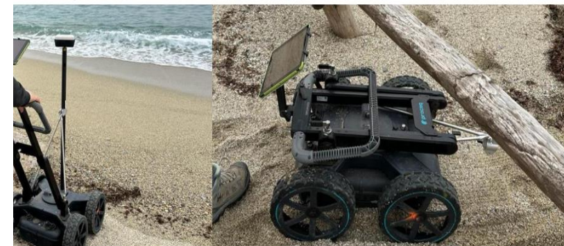
Figura 12 - Scansioni georadar - limiti di penetrazione
